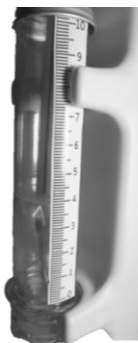
Fig.10. Escala que permite verificar a posição média do êmbolo.
