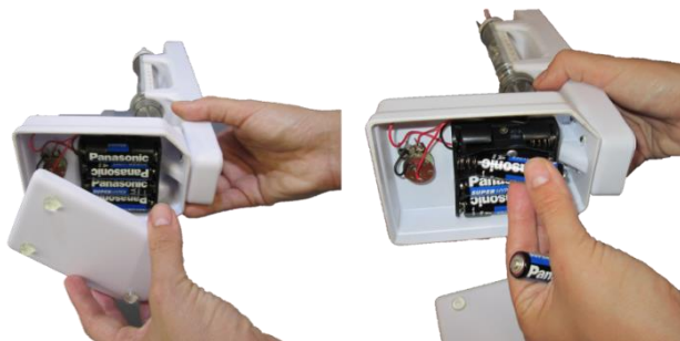
Fig. 2. Retire a parte de baixo do sistema e troque as pilhas.
