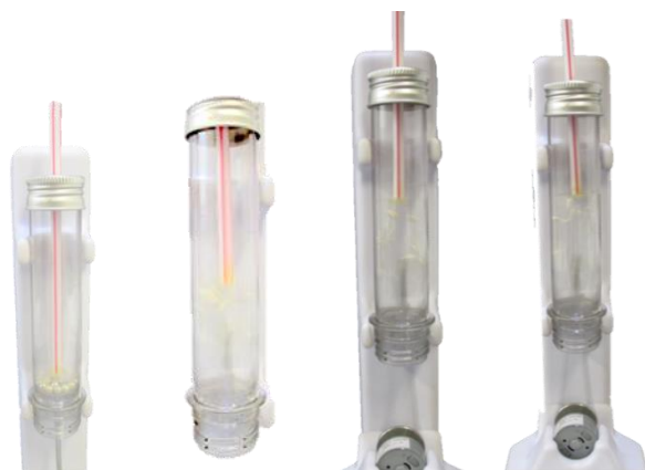
Fig. 7. Pistão mecânico em movimento. (Êmbolo flutuando sob ação das partículas).
